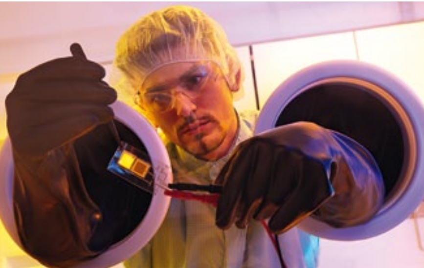
Herstellung von organischen Leuchtdioden: Nicolas Degiorgio arbeitet unter Ausschluss von Sauerstoff und Feuchtigkeit mithilfe einer Stickstoffkammer.
