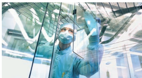
Bayer-Mitarbeiter Michael Delbeck bereitet Polycarbonat-Platten für die Kratzfest-Beschichtung vor.
