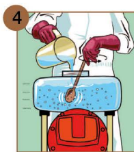
4 Compléter progressivement l'eau pour remplir le réservoir en remuant de sorte à obtenir un mélange homogène
