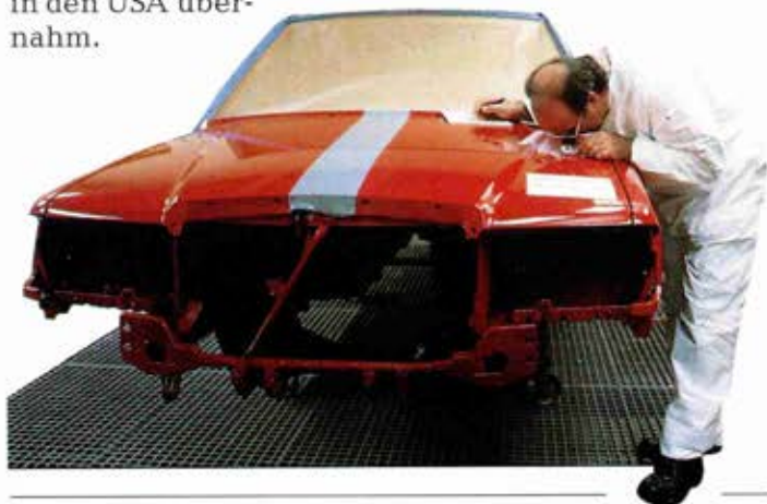
Im Leverkusener Lacktechnikum werden ständig neue Rezepturen erprobt. Hier prüft ein Techniker mit der Lupe die Oberfläche einer frisch lackierten Autokarosserie.
