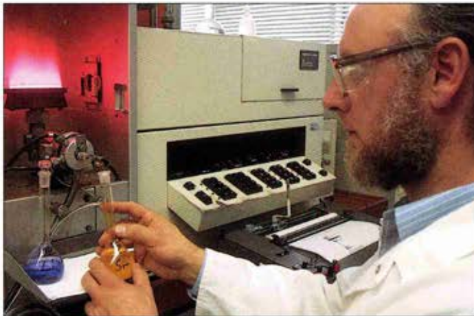
Im Atomabsorptions-Spektrometer können winzigste Spuren von Metallen in Flüssigkeiten – zum Beispiel Abwässern – nachgewiesen werden. Für dieses Foto wurde der kräftige Farbton der Flamme durch Lithium absichtlich herbeigeführt.
