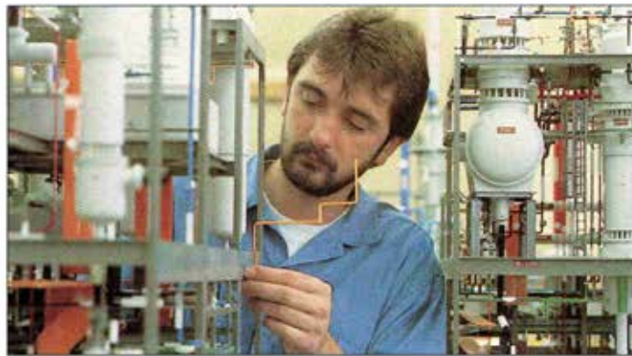
Große Anlagen werden zunächst maßstabsgetreu als Modell gebaut.
