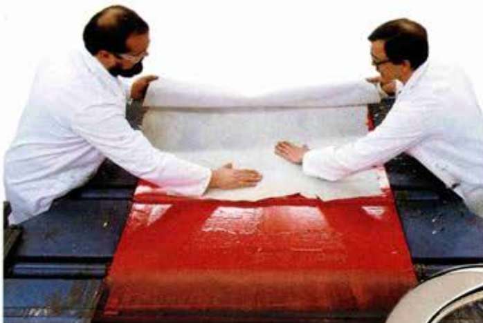
Das von Bayer entwickelte Levacast-Verfahren verleiht weniger attraktivem Spaltleder die charakteristische Lederoberfläche. Es entsteht ein sehr haltbares, strapazierfähiges Material, das sich zu vielerlei Produkten verarbeiten läßt.
